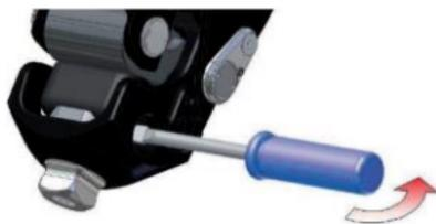
图20 拆卸站立屈曲橡胶
